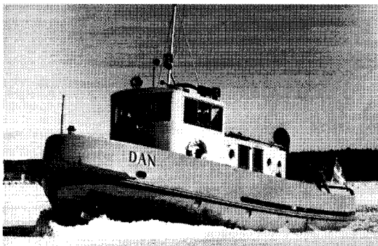
Hamnbåten och isbrytaren Dan med 3 st motorer G-62, med gemensam reduktionsväxel och utrustade med turboaggregat.
